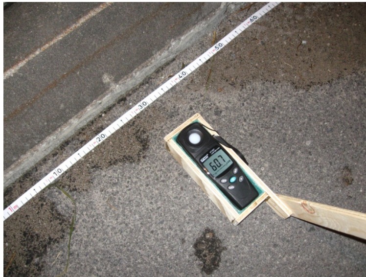
Esempio di misura dell' illuminamento del piano stradale.
